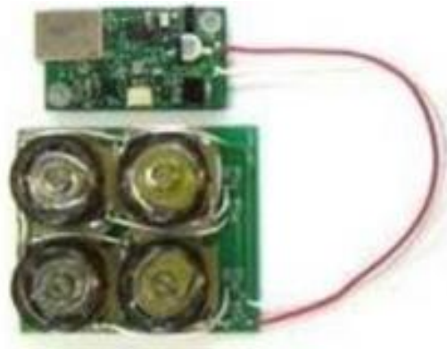
1.7-сурет – Қарапайым қарапайым фотодиодты қабылдағыш
