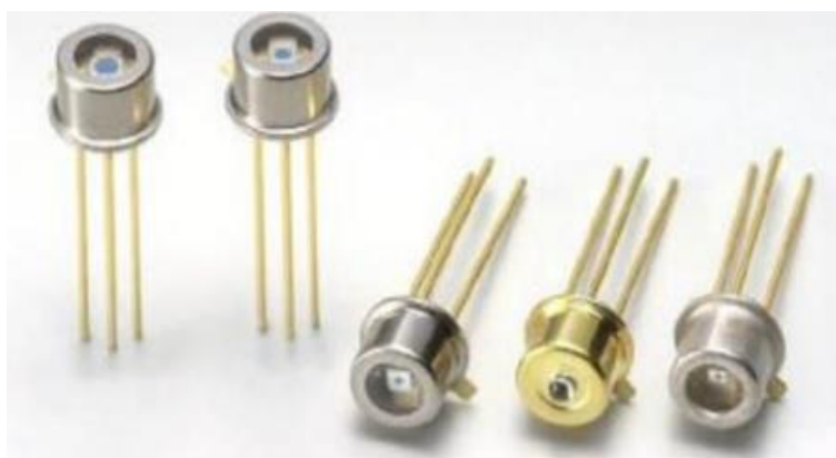
1.5-сурет – 1 ГГц жылдамдығымен Наматсу S5973 сериялы кремнийлі р-і-п фотодиодтары
